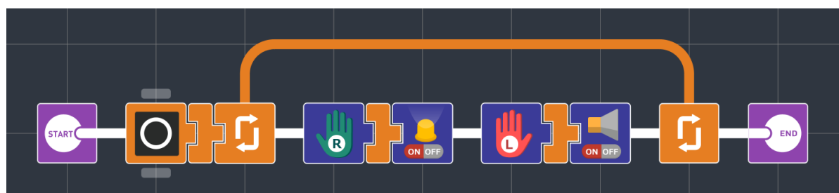
[条件分岐]アイコン無しでタッチセンサーのチェックをする
